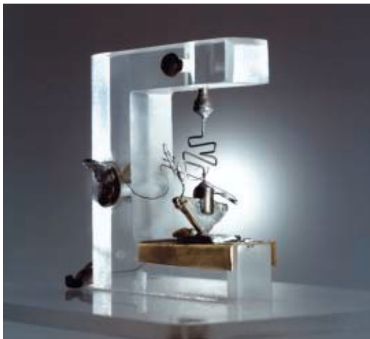
Le premier transistor, mis au point en 1947 dans les laboratoires Bell.
