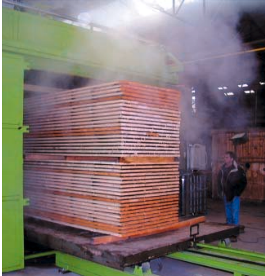
Le bois est porté à plus de 200°C sous atmosphère inerte et à pression contrôlée.
