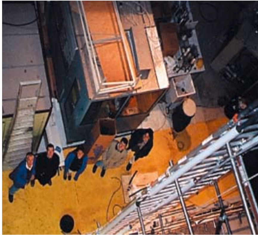
Boucle pilote permettant au centre SPIN de simuler les conditions de formation d'hydrates de gaz dans une canalisation pétrolière en mer profonde. DR
