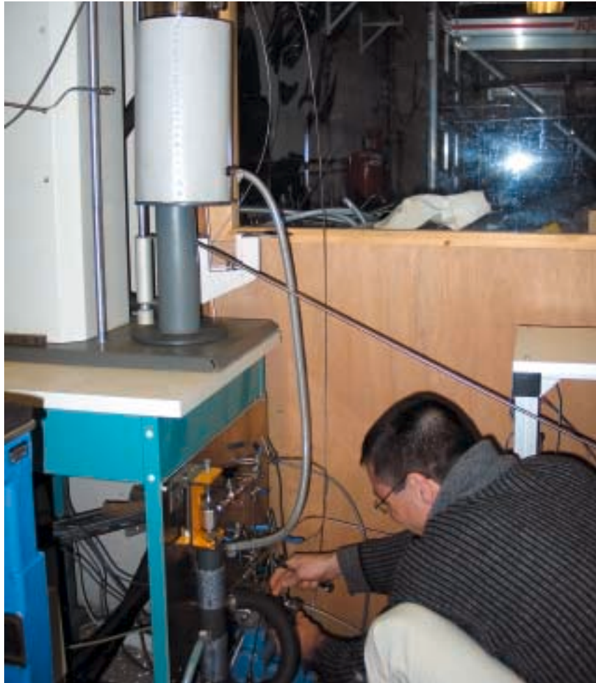
Le centre SPIN possède un appareillage permettant de simuler la cristallisation des hydrates de méthane dans les sédiments sous-marins. DR
