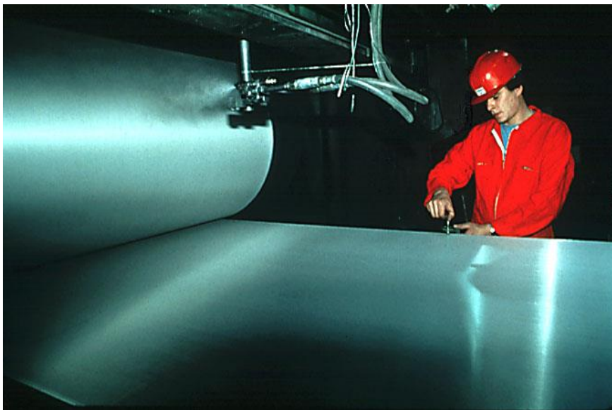
Contrôle de la qualité de laminage (document Pechiney Rhenalu, aujourd'hui Constellium)
